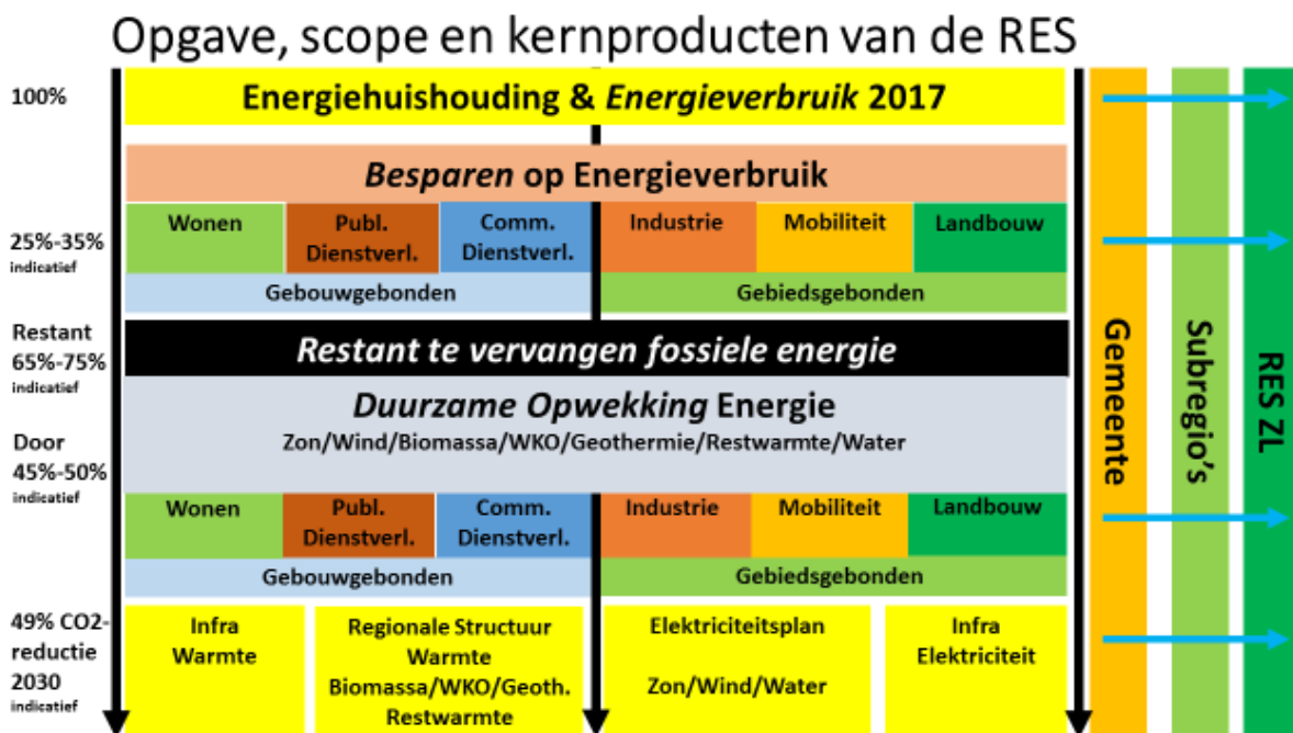
Figuur 1 Schematisch overzicht van de punten 1 t/m 6. Door nulmeting van het peiljaar 2016 wordt het energieverbruik gemeten. Ervaringscijfers leren dat (indicatief) ca. 25%-35% kan worden bespaard. Het restant fossiele energie kan worden vervangen door duurzame energie die véél efficiënter is. Een equivalent van 45%-50% is voldoende. De RESZL zal hiervoor de exacte cijfers bepalen.
