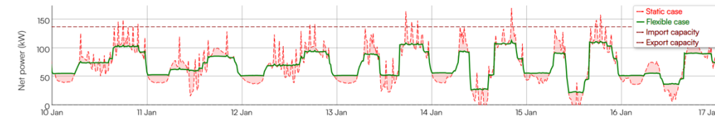
Netbelasting met batterij van 60 kWh capaciteit en 60 kW vermogen
